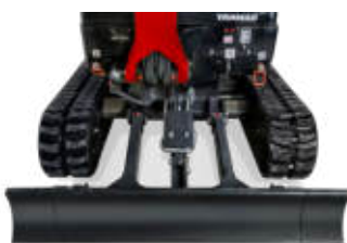
Ausgefahrener Unterwagen: 1170 mm
