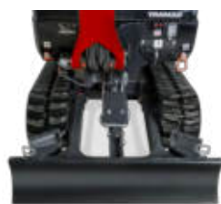
Eingefahrener Unterwagen: 980 mm
