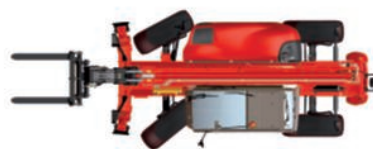
Vorderradlenkung für die sichere Fahrt auf der Straße
