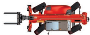
Hundegang für das seitliche Heranfahren und für schwierige Ladevorgänge
