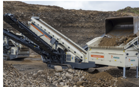
Großer Aufgabebunker ermöglicht einen geschlossenen Kreislauf.
