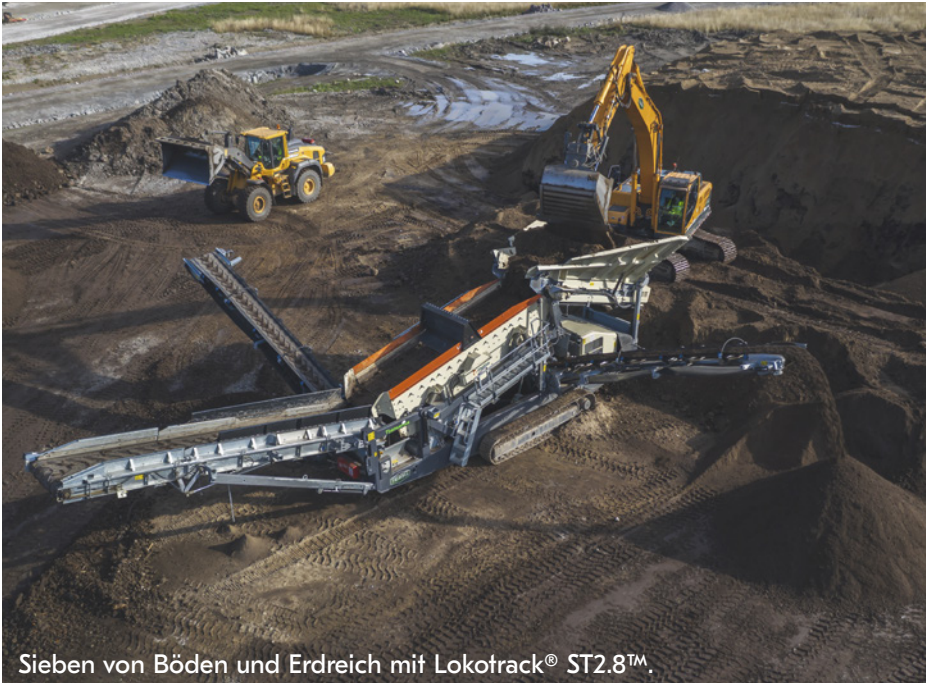
Sieben von Sand und Kies mit Lokotrack® ST2.8™.
