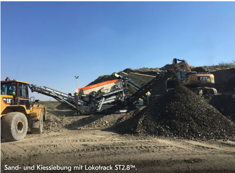
Sieben von Böden und Erdrich mit Lokotrack® ST2.8™.
